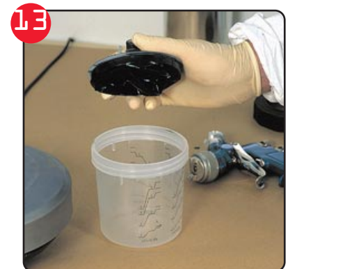
Nach Beendigung des Lackiervorgangs kann der leere, zusammengezogene Beutel samt Deckel in der „Rethmann-Tonne“ entsorgt werden.
