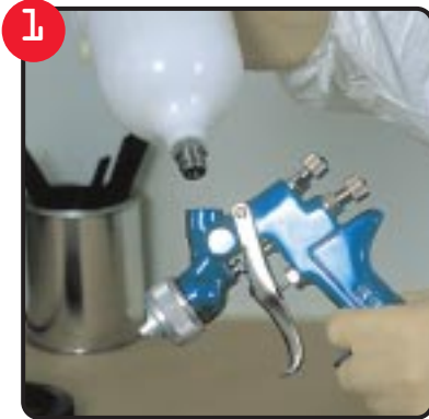
Entfernen des vorhandenen Bechers von der Pistole.
