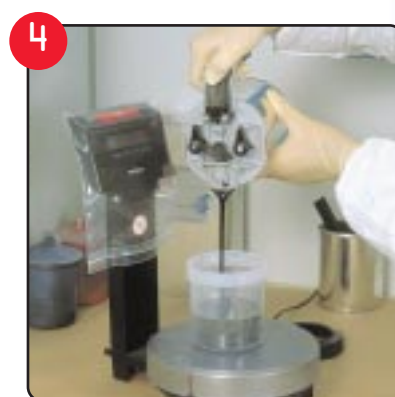
Ablesen der Farbmenge auf der Becherskalierung, oder wie gewohnt durch Abwiegen.
