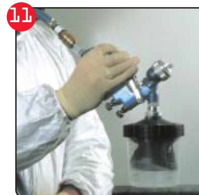
Pistole von der Druckluft abkoppeln. „Über Kopf“ den Abzug durchziehen und den Beutel entspannen.
