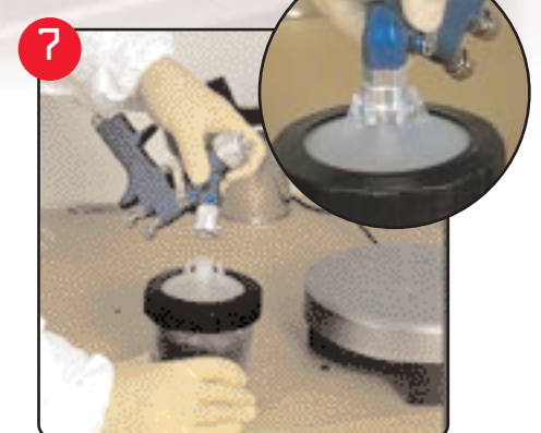
Pistole "kopfüber" per Bajonettverschluss bis zum fühlbaren Einrasten auf dem Becher befestigen.
