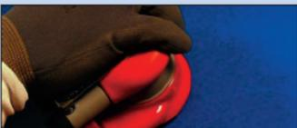
Umgebung inkl. Ausspritzzone mikroschleifen<br>Microponçage de l'environ et du raccord | P800 - P1000     |                                   | 3M 260L Feinschleifmittel trocken oder 3M Trizact P1000 feucht<br>3M 260L Abrasif pour microponçage à sec ou 3M Trizact P1000 humide | Trizact immer feucht verarbeiten<br>Utiliser le Trizact toujours humide                                                            |
