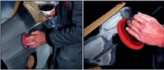
Ausschleifen der Schadstelle<br>Ponçage de l'endroit endommagé                          | P80 - P320       |                                   | 3M 236U Hookit Discs<br>3M 236U Hookit Discs                                                                                         | Einsatz von Kontrollschwarz zwischen Schleifschritten<br>Utilisation du guide de ponçage entre chaque étape de ponçage             |
